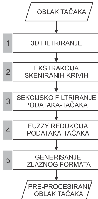
Slika 5.3: Modularna struktura SiPreF sistema [3,9]
