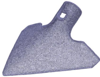
b) poligonalni (triangulirani) model
